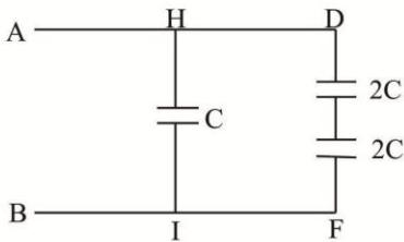
Os capacitores entre os pontos  $D$  e  $F$  estão em série e o capacitor equivalente é:
