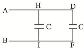
Os capacitores estão agora em paralelo e o capacitor equivalente é  $C_{eqAB} = C + C = 2C$ , que é o capacitor equivalente do circuito inicial.
