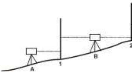
Obs.: A altura do instrumento nos pontos A e B é de 1,00 m, e a cota do ponto A é de 42,5 m.
